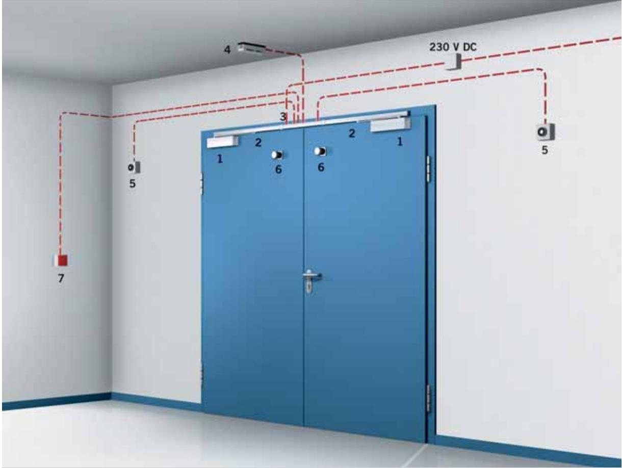
**Uygulama Örneği;** DORMA TS 93 B kapı kapatıcı (1); DORMA GSR/EMF sıralama mekanizması (2); DORMA RMZ-K duman dedektörü (3); DORMA RM duman dedektörü (4); DORMA EM 500 G elektro mıknatıs (5); DORMA MAT Mıknatıs plakası (6); DORMA HT serbest bırakma butonu (7)
