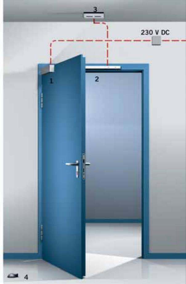
**Uygulama Örneği:** Kapı kapatıcı DORMA TS 93 (1): Kayar kol mekanizması güç besleme ünitesi ve entegre duman dedektörü DORMA G-EMR (2): Tavana monte duman dedektörü DORMA RM (3): Kapı stoperi TZ 5000 (4):
